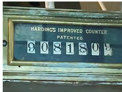
Contador de revoluciones en la máquina de vapor del "Tower bridge" de Londres.
