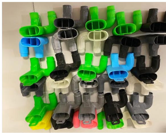
Piezas para la adaptación de máscaras "easybreath" a la utilización por pacientes. Fuente: https://twitter.com/3d_maranon
